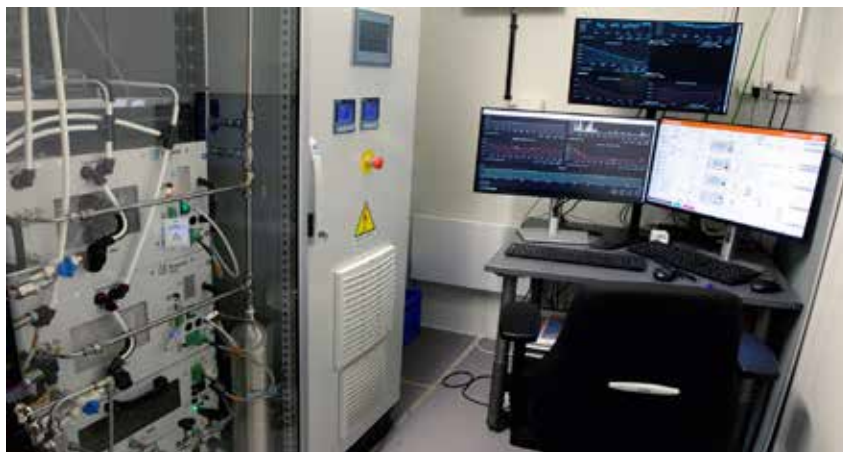
Kuva 2. VTT:n tutkimuskäyttöön kehitetty AEMEL-elektrolyysijärjestelmä mahdollistaa vedytuotannon, järjestelmän suorituskyvyn sekä mittaus- ja valvontamenetelmien tutkimisen hallituissa olosuhteissa.
