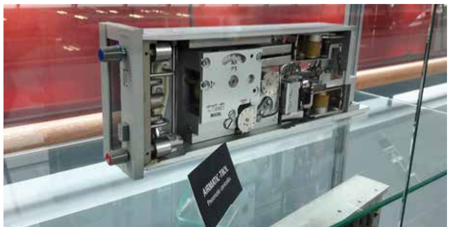
Honeywellin valmistama, kentälle asennettava pneumaattinen PID-säätäjä.
