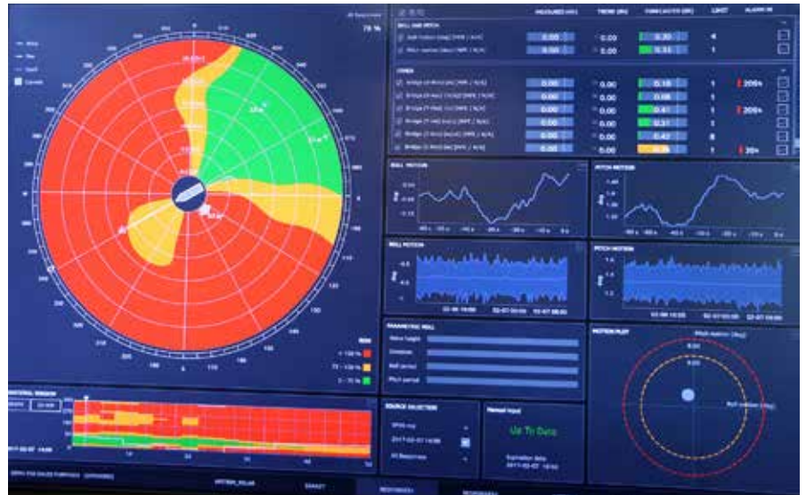
Etävalvonta saa runsaasti tietoa muun muassa laivan kallistuksesta ja liikkeestä.
