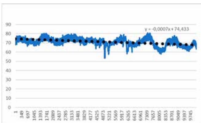
Kuva 3. Mittausaineistosta estimoitu lämmönsiirron hyötysuhde ja sen muutos, esimerkkinä kaukolämmönvaihdin (simulointiaika kuvassa yksi viikko).
