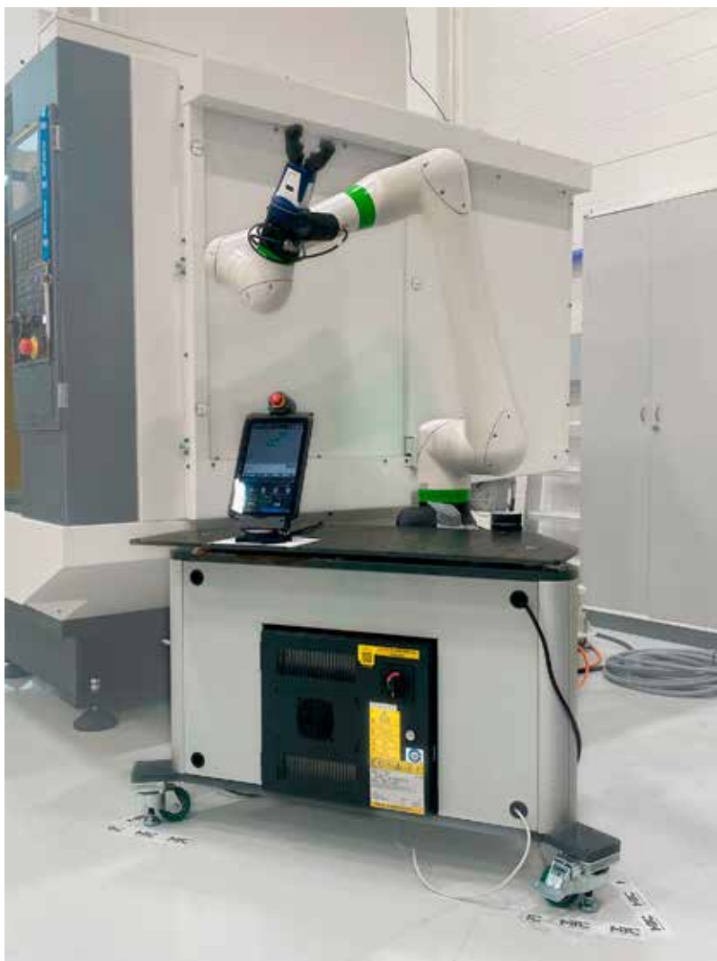
MTC Flextekin kehittämä MTCF Mobile Cell -konseptissa cobotti on asennettu liikuteltavalle alustalle, sen liittynyt ja ohjelmistorakenteet ovat käyttövalmiina ja erilaiset yhteensopivat tarrutjat valittavina.
