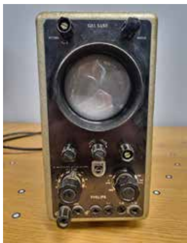
Philips Oszillograph GM 5650 vuodelta 1956
