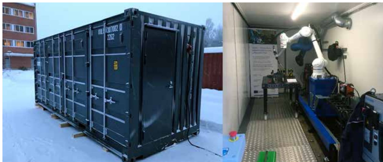
Centrian robotti-hitsauslaitteisto kulkee siirrettävänä kokonaisuutena 20 jalan merikontissa. (Kuva: Centria, 2024.)
