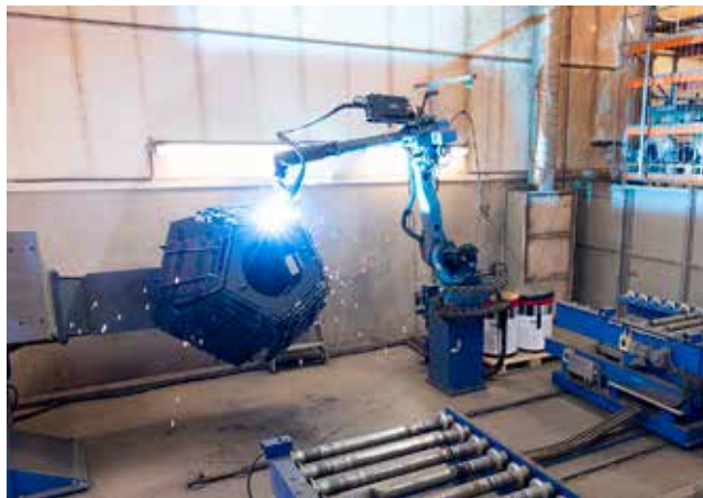
Hitsattavat kappaleet siirtyvät Ratesteel Oy:n robottihitsaus FMS-järjestelmään automaattisesti palettiradalla.
