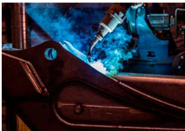
Metsäkoneen puomin robottihitsausta.
