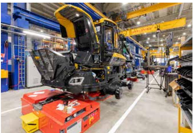
Ponsen kokoonpanolinjalla metsäkoneet liikkuvat vihivaunujen päällä.
