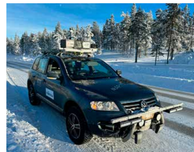
Ohjelmisto IP:n kehittämistä 'Martti' automaattiautoon, kun kaistaviivat eivät ole näkyvissä. Dynaaminen maamerkki -pohjainen paikannus on osaltaan myös patentoitu.
