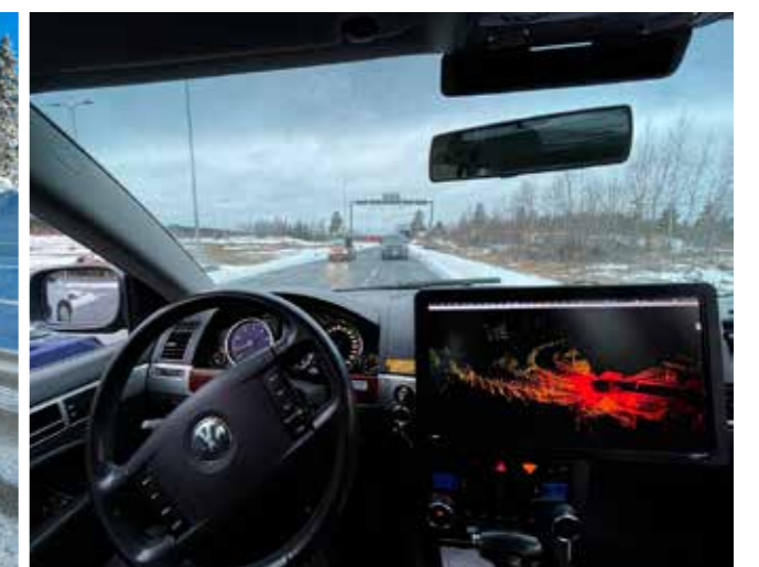
Ohjelmisto IP:n kehittämistä 'Martti' automaattiautoon, kun kaistaviivat eivät ole näkyvissä. Dynaaminen maamerkki -pohjainen paikannus on osaltaan myös patentoitu.
