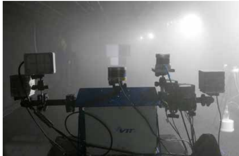
Automaattiajoneuvon anturijärjestelmien ominaisuuksien parantaminen eri keliolosuhteissa käyttäen sumukammiota. Tämän pohjalta mm. parametrien automaattisäätö on patentoitu.
